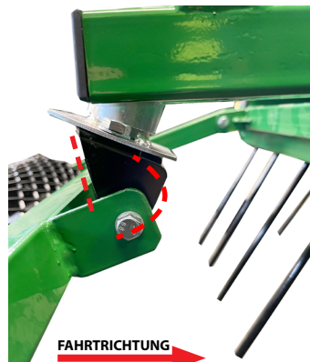
Siehe Winkel der Befestigungsplatte bei der Montage.
