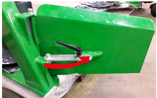
Montieren Sie die Halterung und schrauben Sie den Handgriff zurück. Wiederholen Sie die Schritte auch auf der rechten Seite des Kreiselmähdwerks.
