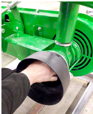
Lösen Sie die Schrauben und montieren Sie die Abdeckung.
